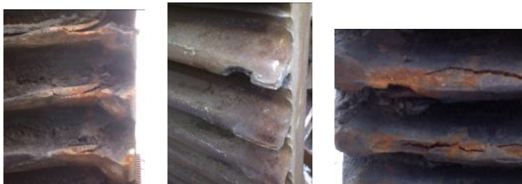
Рисунок 1 - Износ зубьев зубчатого венца шаровой мельницы
