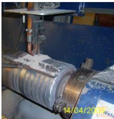
Рисунок 2 – Восстановление поверхности ролика на наплавочном станке Weldclad 2000
